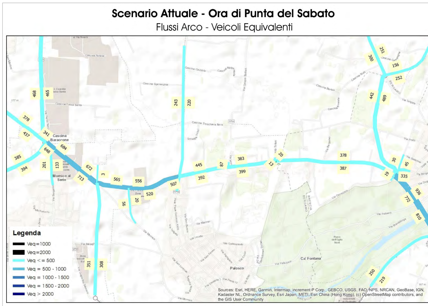
Figura 48 – Scenario Attuale – Ora di punta del sabato – Flussogramma area vasta– Veicoli Equivalenti
