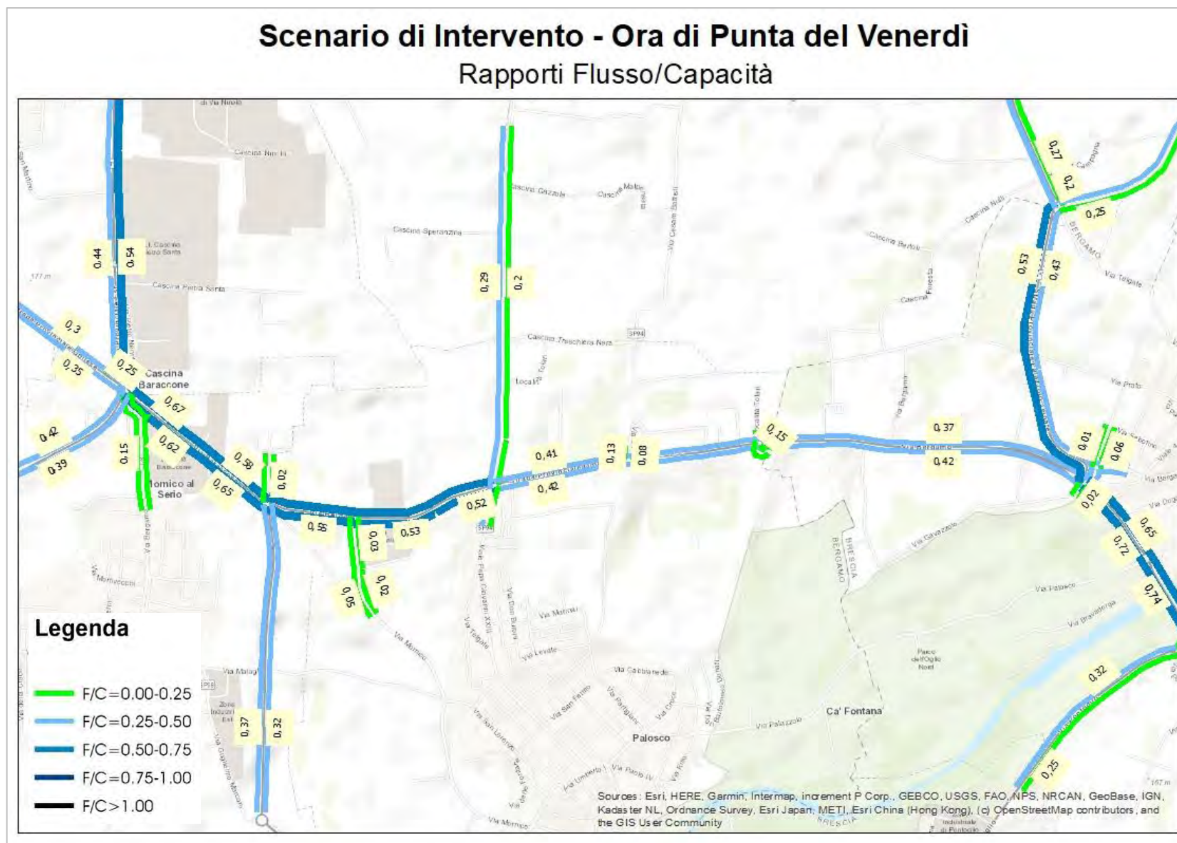
Figura 76 – Scenario di Intervento – Ora di punta del venerdì – Rapporti Flusso/Capacità
