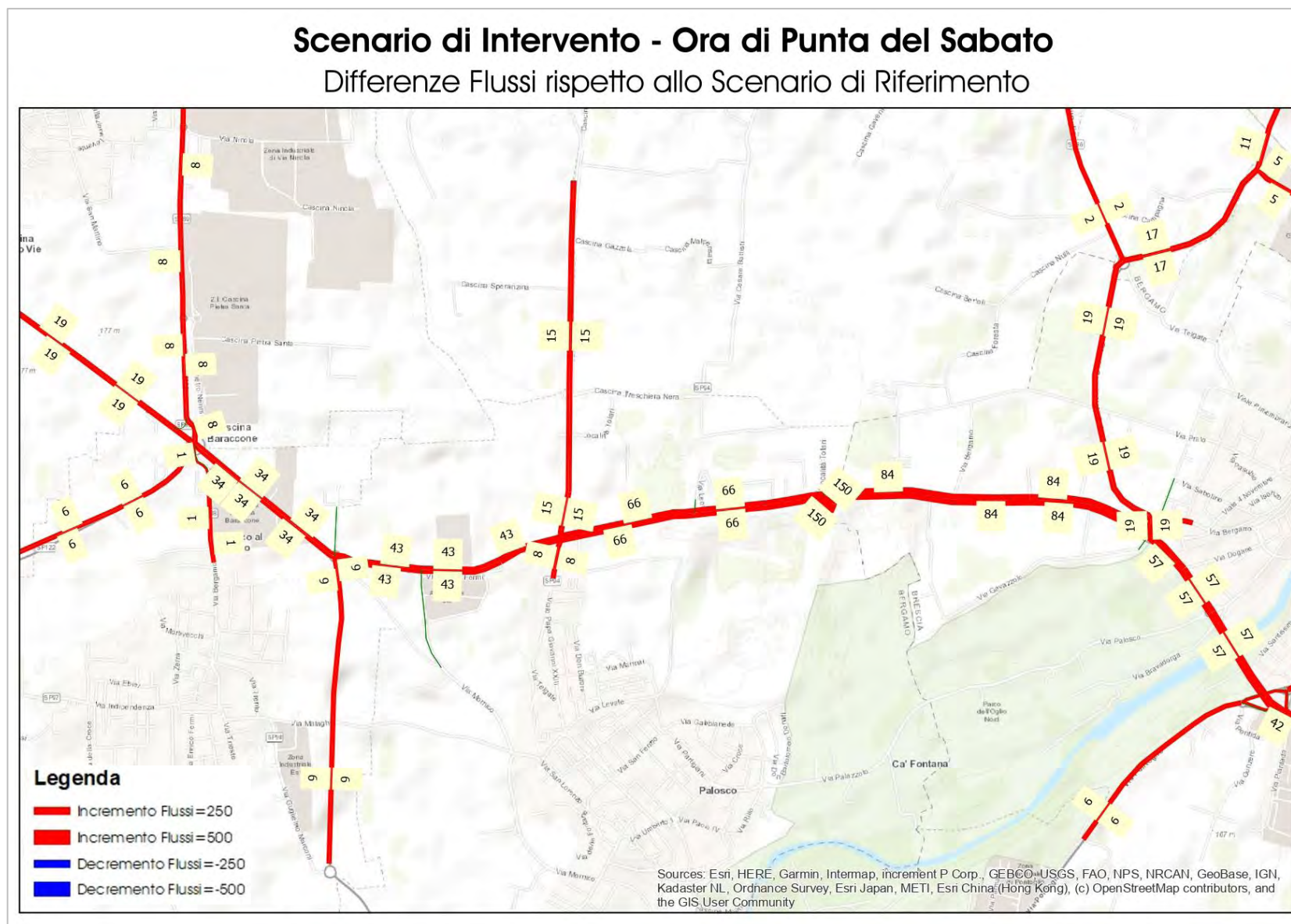
Figura 81 – Scenario di Intervento – Ora di punta del sabato – Differenza flussi rispetto allo Scenario di Riferimento
