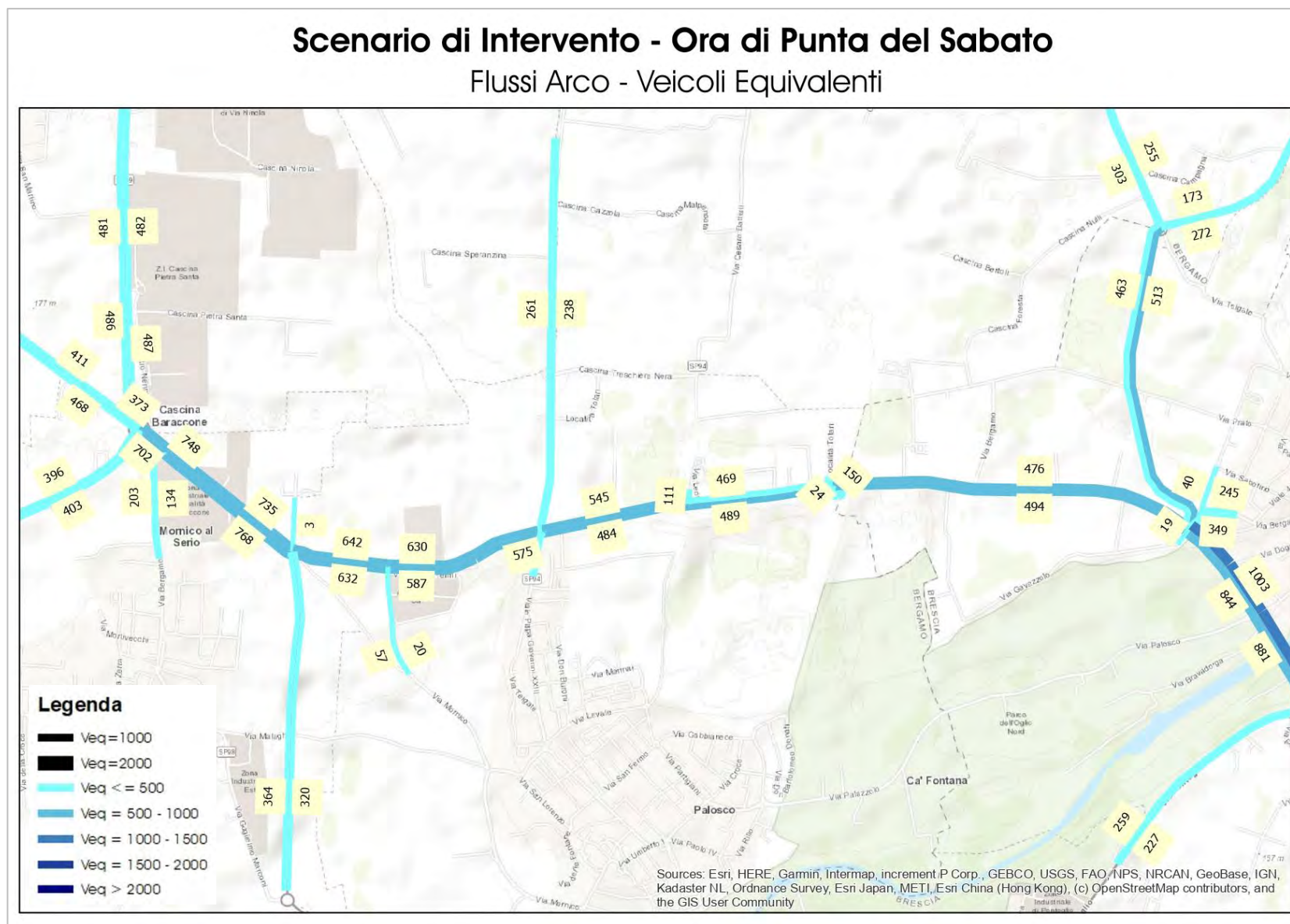
Figura 79 – Scenario di Intervento – Ora di punta del sabato – Flussogramma area – Veicoli Equivalenti
