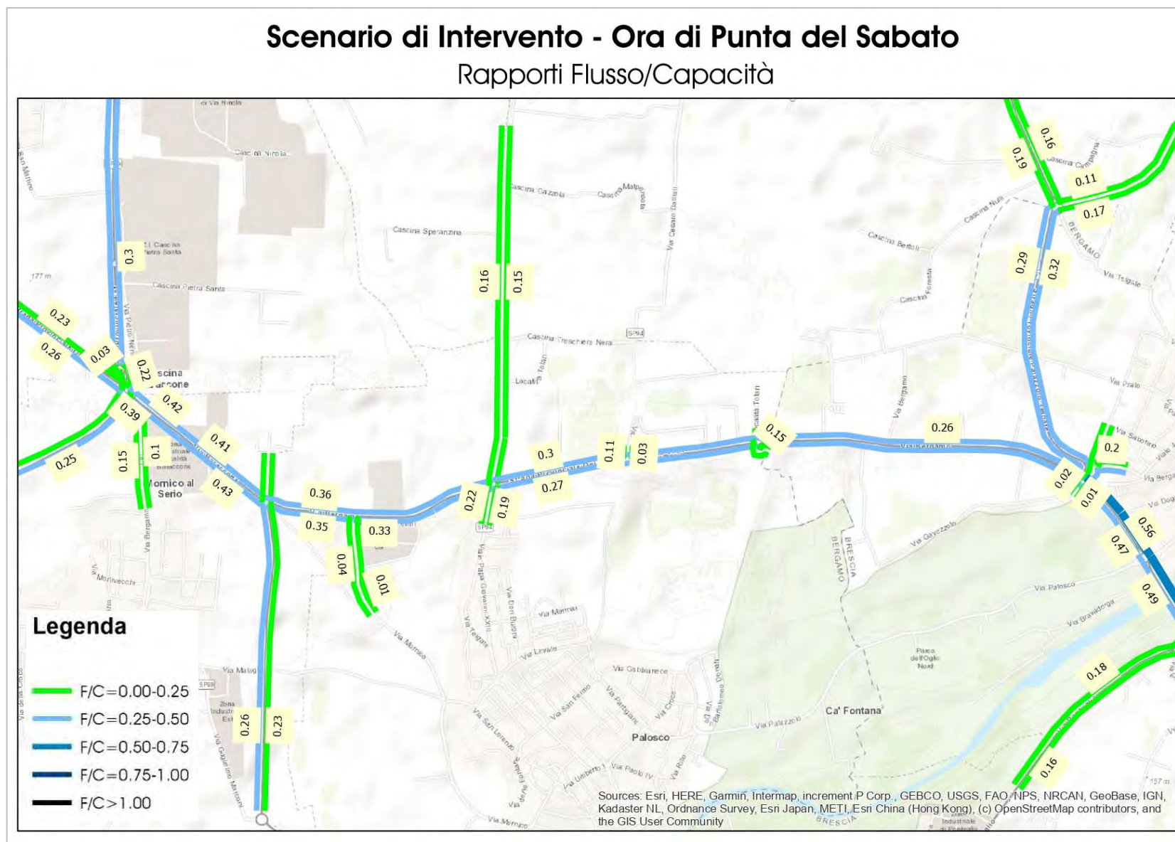
Figura 80 – Scenario di Intervento – Ora di punta del sabato – Rapporti Flusso/Capacità
