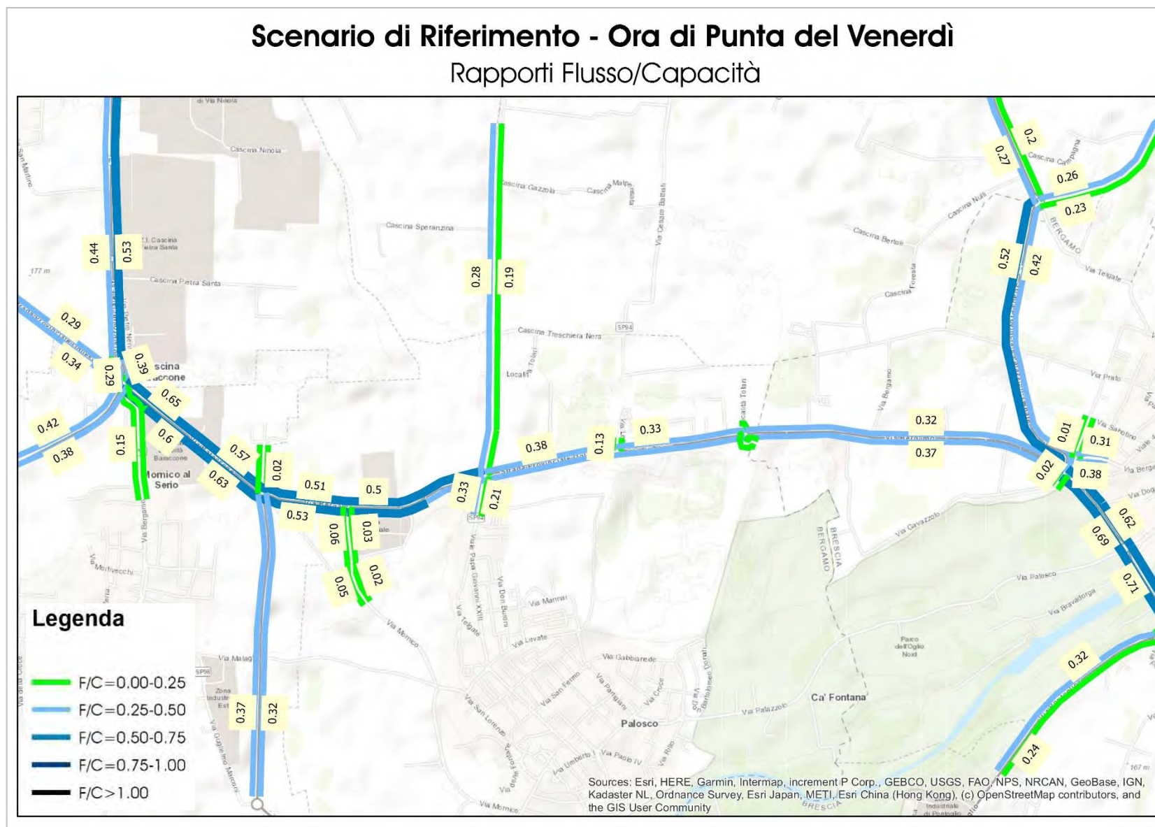
Figura 59 – Scenario di Riferimento – Ora di punta del venerdì – Rapporti Flusso/Capacità
