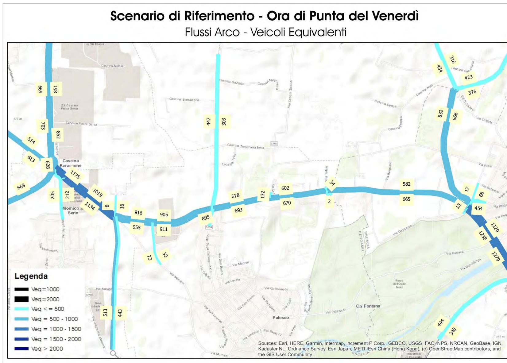
Figura 58 – Scenario di Riferimento – Ora di punta del venerdì – Flussogramma – Veicoli Equivalenti
