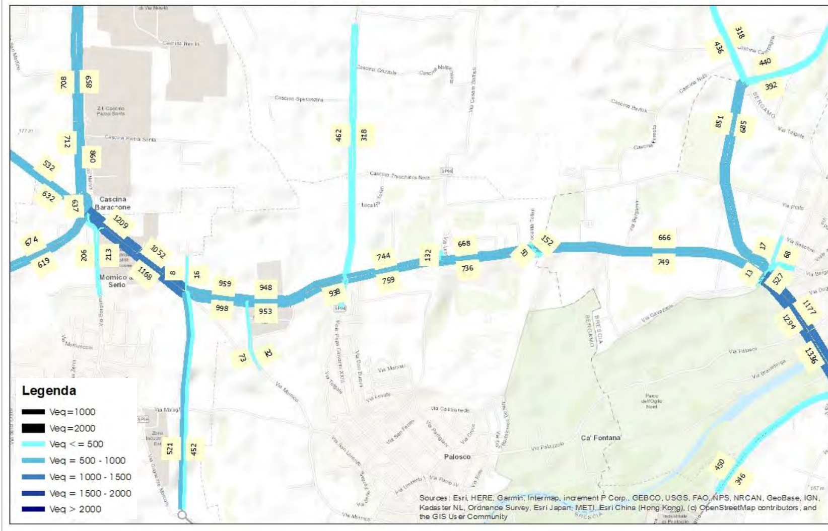
Figura 75 – Scenario di Intervento – Ora di punta del venerdì – Flussogramma – Veicoli Equivalenti
