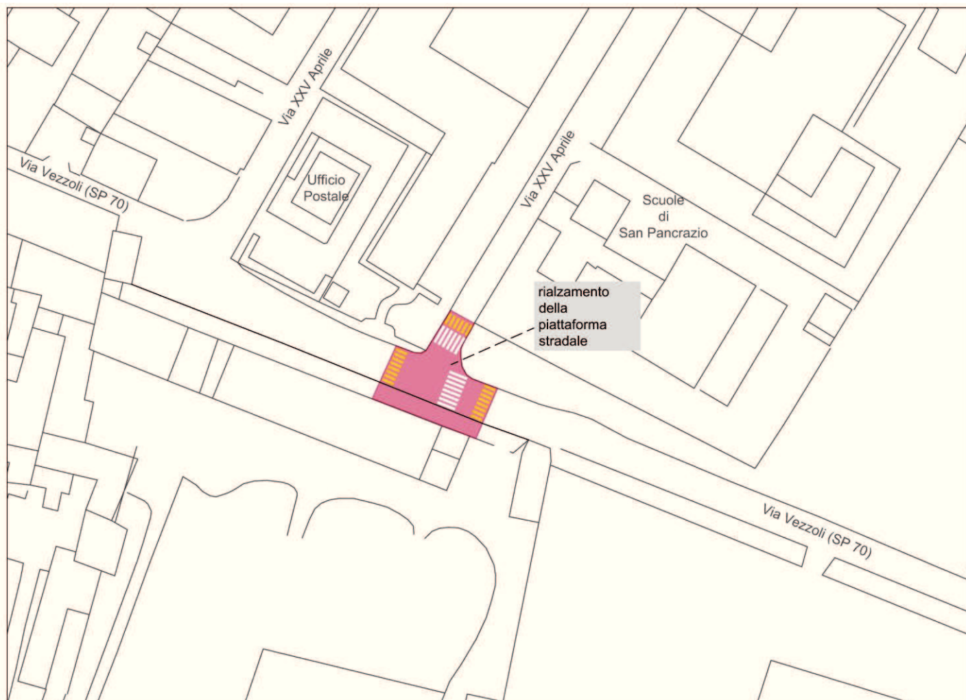
Figura 5.11.2 – Intervento di Moderazione del Traffico intersezione Via Vezzoli – Via XXV Aprile
