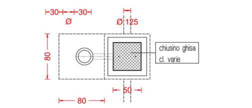
PARTICOLARE PLINTO E POZZETTO ISPEZIONE ILLUMINAZIONE PUBBLICA scala 1:25
