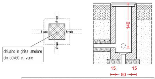
PARTICOLARE POZZETTO ISPEZIONE scala 1:25
