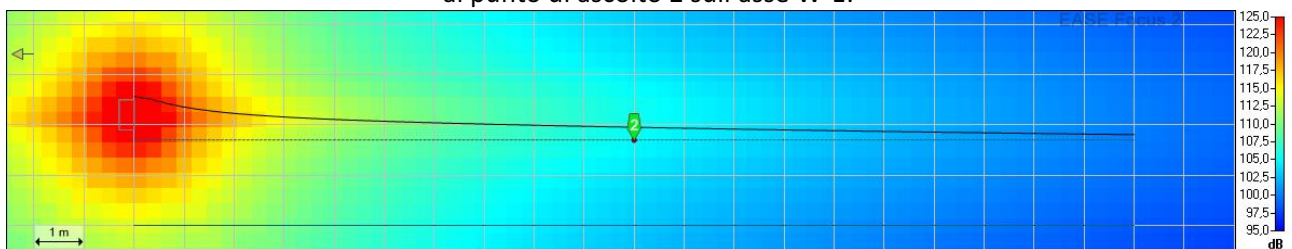
Fig 3: Vista in sezione della copertura sonora del sistema tradizionale al punto di ascolto 2 sull'asse W-E:
