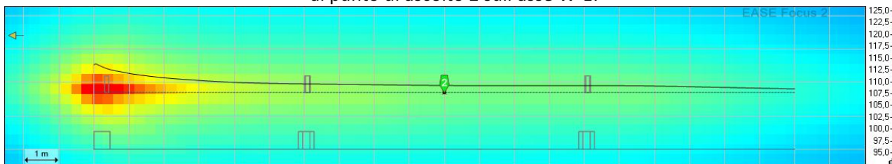
Fig 7: Vista in sezione della copertura sonora del sistema multidiffusione al punto di ascolto 2 sull'asse W-E:
